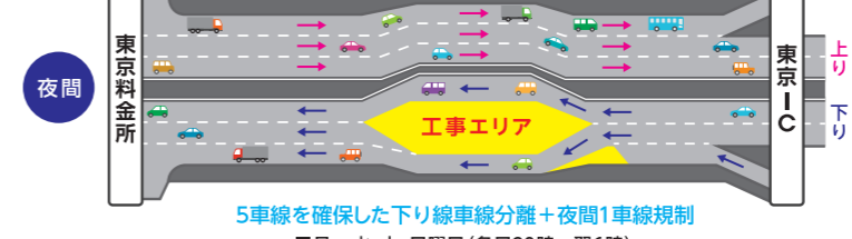
5車線を確保した下り線車線分離+夜間1車線規制 ■月～水・土・日曜日（各日20時～翌6時）
