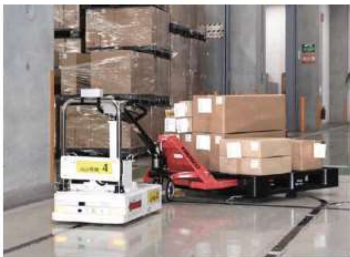
【荷物をハンドリフトごと牽引し、目的地へ自動搬送する様子】
