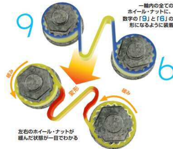
ホイール・ナットマーカ の装着例 ホイール・ナット回転指示インジケータ ー (ISO方式)装着の場合
