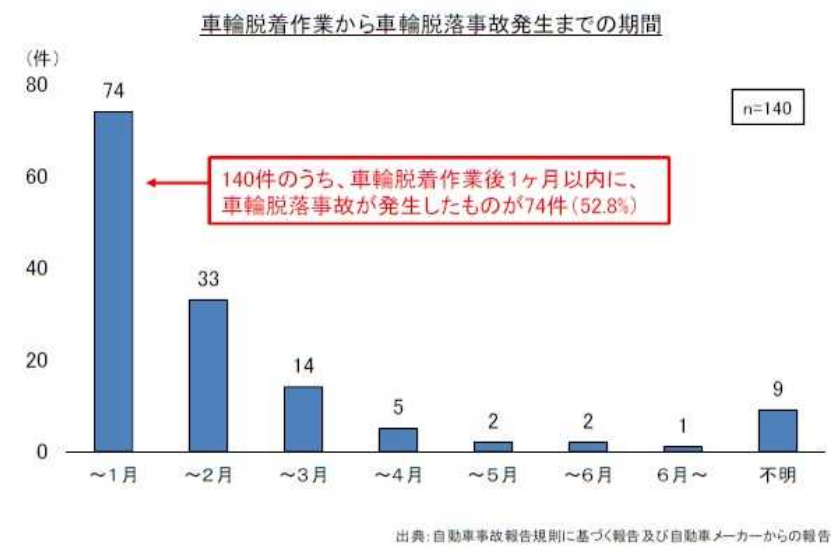
車輪脱落事故発生状況（令和4年度）
